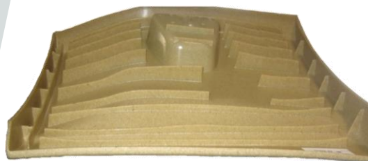
Abbildung 11: In Kombination mit CADMOULD Fiber berücksichtigt CADMOULD Warp auch die Faserorientierung. Die Genauigkeit der Verzugsergebnisse wird hier am Beispiel eines Handschuhfachs (obere Hälfte) für ein naturfaserverstärktes Material gezeigt. Die Kombination von Warp mit VARIMOS bringt den zusätzlichen Vorteil, dass der Verzug mit automatisierten Methoden optimiert werden kann.
